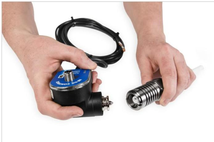
Отделите электронный блок от механической части датчика.
