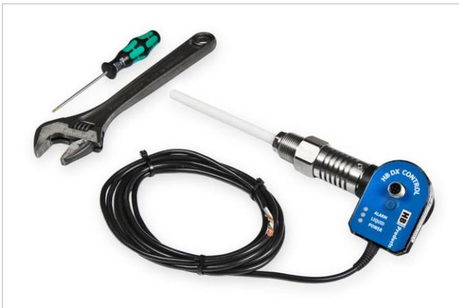
Для монтажа датчика HBLC необходимо использовать шестигранный ключ на 2,5 мм разводной ключ и герметик, соответствующий типу резьбы.
