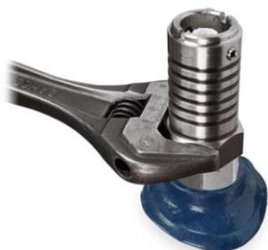
Установите механическую часть датчика на резервуар и обеспечьте затяжку в соответствии с типом и размером резьбы (80 - 150 Нм).
