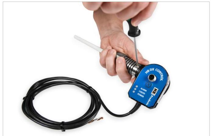
Ослабьте 2 установочных винта, фиксирующих электронный блок на механической части датчика
