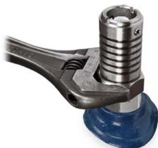
Установите механическую часть в резервуар или колонку уровня и затяните (с усилием от 80 до 150 Нм).
