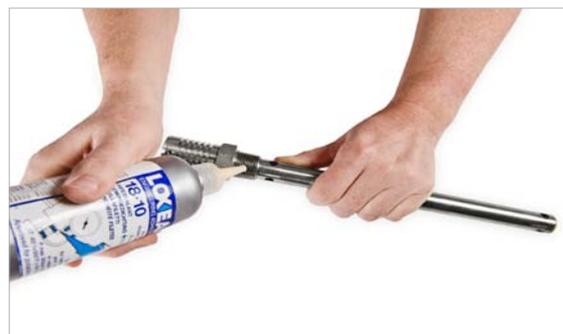
Нанесите герметик или фторопластовую ленту на коническую резьбу.
