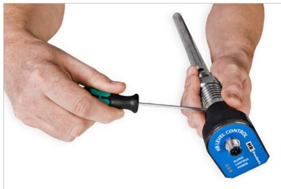
Ослабьте 2 фиксирующих винта крепления блока электроники к механической части.
