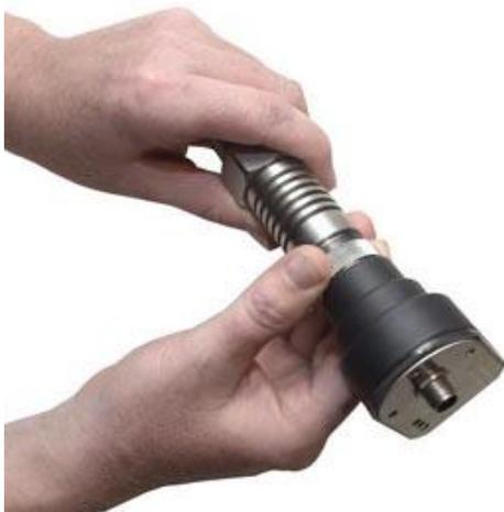
Отделите электронный блок от механической части датчика.
