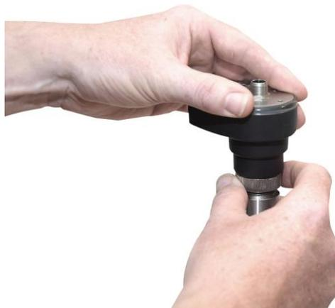
Установите механическую часть датчика на сосуд или колонку уровня и затяните моментом, соответствующим типу резьбы (80-150 Нм).
