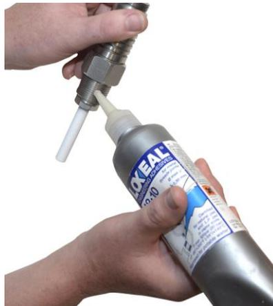
Для установки датчика HBLC-R-IP необходимо иметь в наличии универсальные плоскогубцы, SW 32 (или раздвижной гаечный ключ), жидкий герметик и моментную отвертку.
