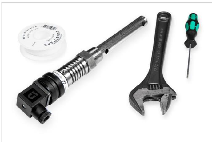
Для установки датчиков с использованием конической резьбы требуется разводной ключ, торцовый ключ на 2,5 мм и фторопластовая лента или жидкий герметик. Для резьбовых соединений других типов применяются твердые прокладки.
