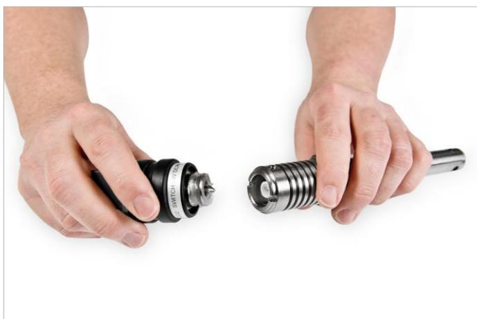
Отделите электронный блок от механической части датчика.
