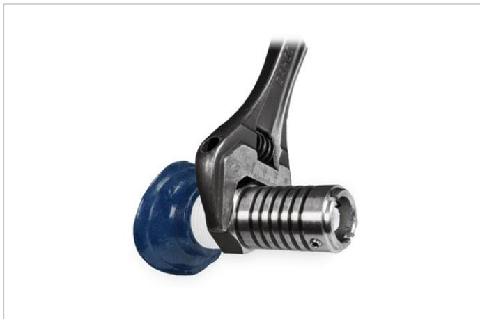
Установите механическую часть датчика и обеспечьте затяжку в соответствии с типом и размером резьбы (80 - 150 Нм).
