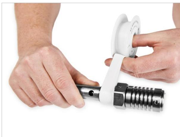
Нанесите жидкий герметик или фторопластовую ленту на коническую резьбу. Для резьбовых соединений других типов применяются твердые прокладки.
