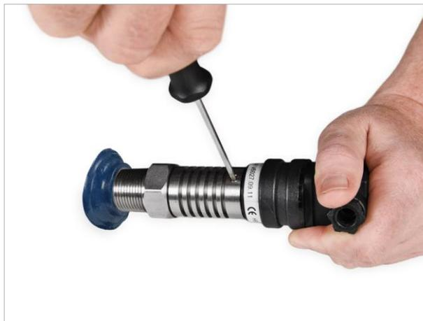
Установите электронный блок на место и зафиксируйте двумя установочными винтами.
