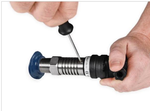
Снова установите электронную часть и зафиксируйте ее 2 установочными винтами.
