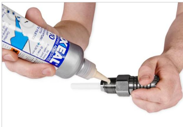
Нанесите герметик на датчики с конической резьбой и установите плотную прокладку на датчики с цилиндрической резьбой.
