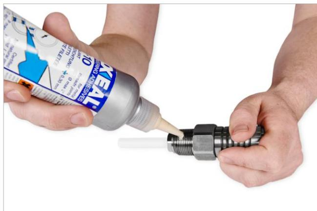
Нанесите герметик на датчики с конической резьбой и установите плотную прокладку на датчики с цилиндрической резьбой.
