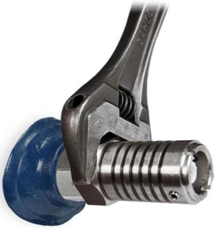
Установите механическую часть в колонке уровня и затяните ее с усилием затяжки в зависимости от типа резьбы (80-150 Нм)
