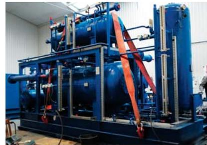
Так, одним из последних проектов, выполненных ООО «КУЛТЕК», было изготовление трех компрессорных аммиачных установок для отсасывания паров аммиака при хранении и наливе.
