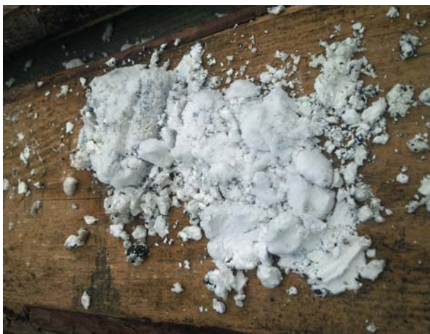
Пример парафинизации масла из-за неправильной организации маслоотделения
