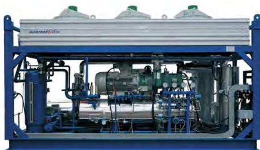
Для холодоснабжения крытых катков ОАО «Газпром» были разработаны и произведены чиллеры единичной холодопроизводительностью 316 кВт ( $t_0/t_k = -18/+45$  °C) на хладагенте R404A для охлаждения этиленгликоля.
