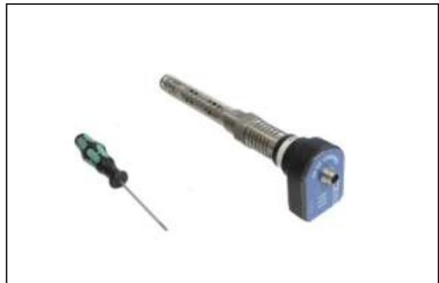
Ослабьте 2 установочных винта, фиксирующих электронный блок на механической части датчика. Отделите электронный блок от механической части датчика.
