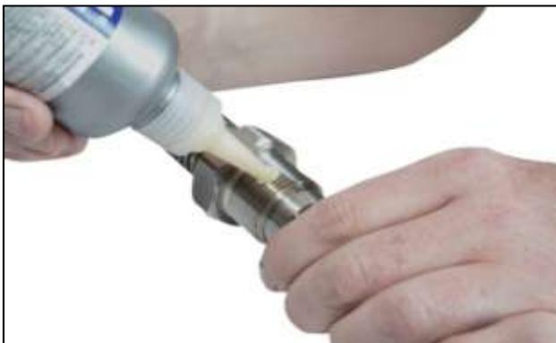
Нанесите жидкий герметик или фторопластовую ленту на коническую резьбу. Установите механическую часть датчика и обеспечьте затяжку в соответствии с типом и размером резьбы (80 - 150 Нм).
