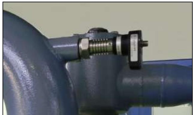
Установите электронную часть на место и закрепите двумя болтами.
