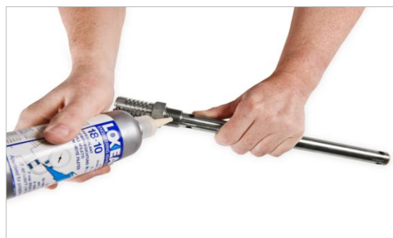
Нанесите жидкий герметик или фторопластовую ленту на коническую резьбу
