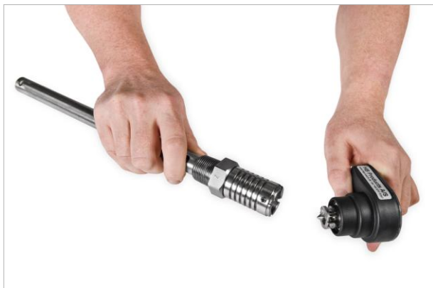
Отделите электронную часть от механической части
