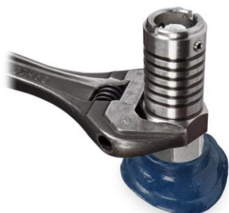
Установите электронную часть в сосуд или колонку уровня и затяните (с вращающим моментом 80-150 Нм)
