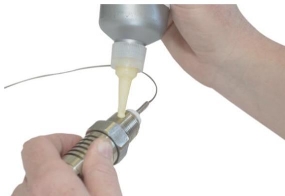
Нанесите жидкий герметик или фторопластовую ленту на коническую резьбу .
