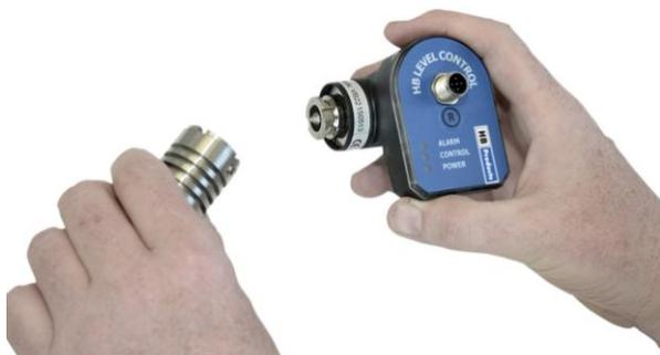
Отделите электронную часть от механической части .
