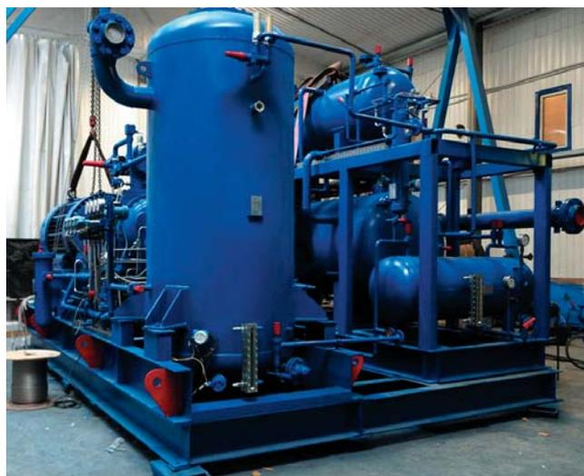
Рис. 2. Взрывозащищенные установки по сжижению аммиака на базе компрессорных агрегатов (ОАО «Щекинский Азот»)
