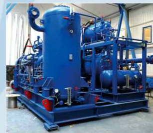
Фото 3, 4. Взрывозащищенные установки по сжижению аммиака в технологическом цикле наливки и хранения.
