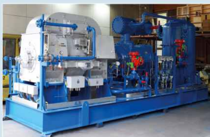
Фото 5. Взрывозащищенная установка по компримированию этилена.
