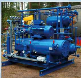
Фото 3, 4. Взрывозащищенные установки по сжижению аммиака в технологическом цикле наливки и хранения.
